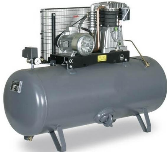
Zweistufiger, zweizylindriger Kolbenkompressor in robuster Bauweise. Der Antrieb erfolgt bei sehr niedrigen Drehzahlen keilriemengetrieben über einen IP 54 Hochleistungs - Elektromotor.
